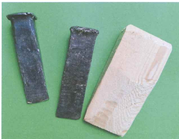
Konek de fèr e de legn - cunei in ferro e in legno.
