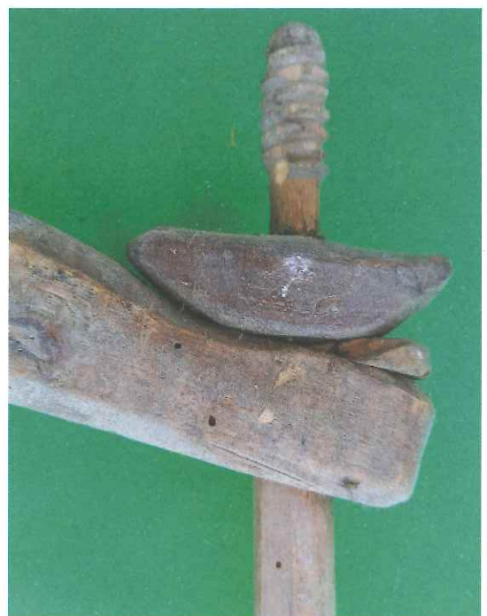
Vida per tirà la lama - vite per tendere la lama. Particolare.
